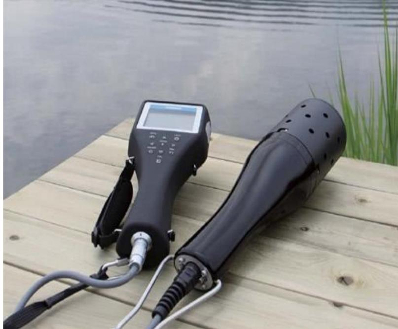
**Figura 17:** Fotografia do Aparelho Horiba U 50, utilizado na mensuração em campo de qualidade das águas superficiais na bacia do rio Formoso, no Município de Bonito/MS, em 2013 e 2014.
